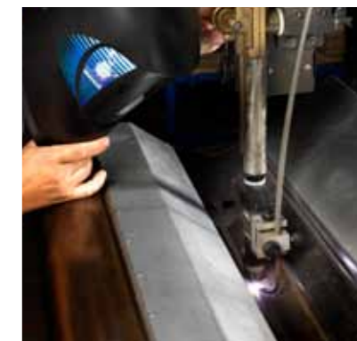
Plasma i langsømsautomat - rustfaste svøb
