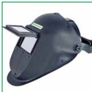
MIGA FLIP-UP SVEJSEHJELM Svejseshjelm med flip-up. Udstyret med 60 x 110 mm passivt svejseglas. Hjelmen leveres som standard med DIN 10 glas.
