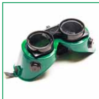
SVEJSE-/SLIBEBRILLE Kombineret svejse- og slibebrille med runde glas i carborund. Slibebrillen er fast, mens svejsebrillen kan vippe. Flere muligheder for isætning af glas alt efter behov og anvendelse. Anvender glas i ø50 mm.
